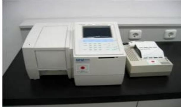
Gambar 2.4 Spektrofotometri Uv-Vis
