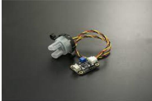
Gambar 2. 2 Sensor Pengukur Kekeruhan Air
