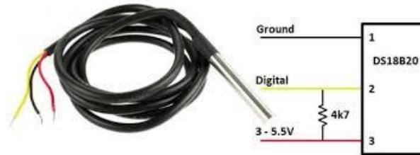
Gambar 2. 4 Sensor DS18B20 atau Sensor Temperatur Air
