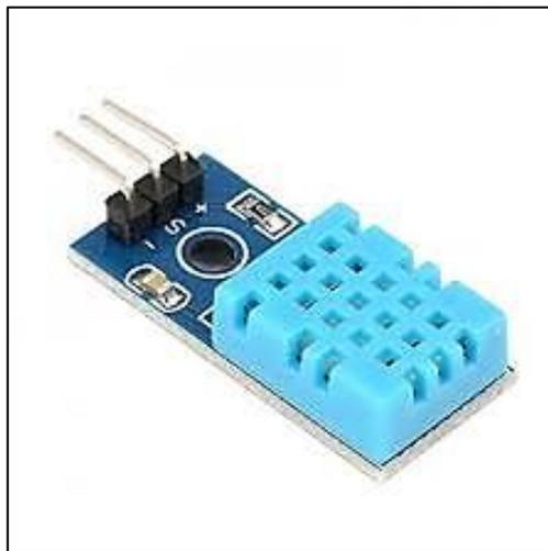
Gambar 2.6 Sensor Suhu dan Kelembaban DHT11
