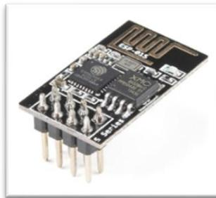
Gambar 2. 9 Modul ESP8266
