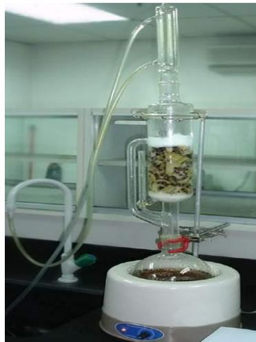
Gambar 2.10 Ekstraksi dengan Soxhlet
