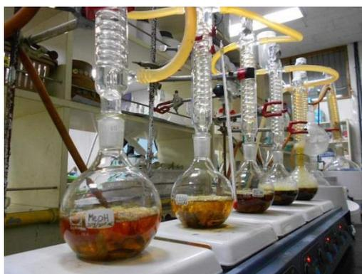
Gambar 2.9 Ekstraksi dengan Reflux.
